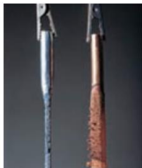
تغییر شکل تیغه ها پس از کار کردن در سلول گالوانی روی-مس
